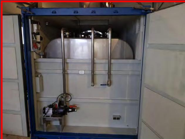
Frontansicht TIW 25m<sup>3</sup> mit Eingebauter Pumpe
